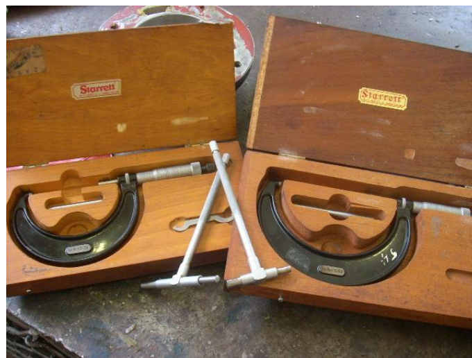
Metrología, micrómetro y telescópicas – Bomba de alimentar caldera Unidades 1 y 2.
