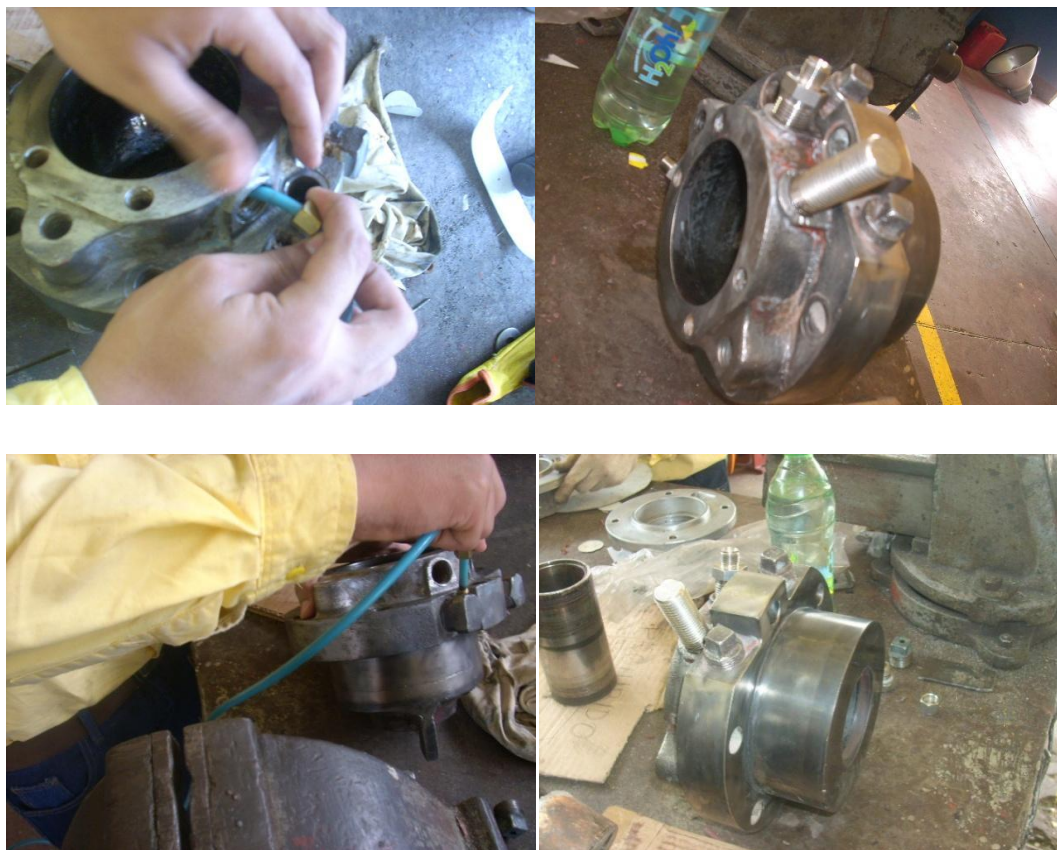
Limpieza del housing o porta empaques – Bomba de alimentar caldera Unidades 1 y 2.
