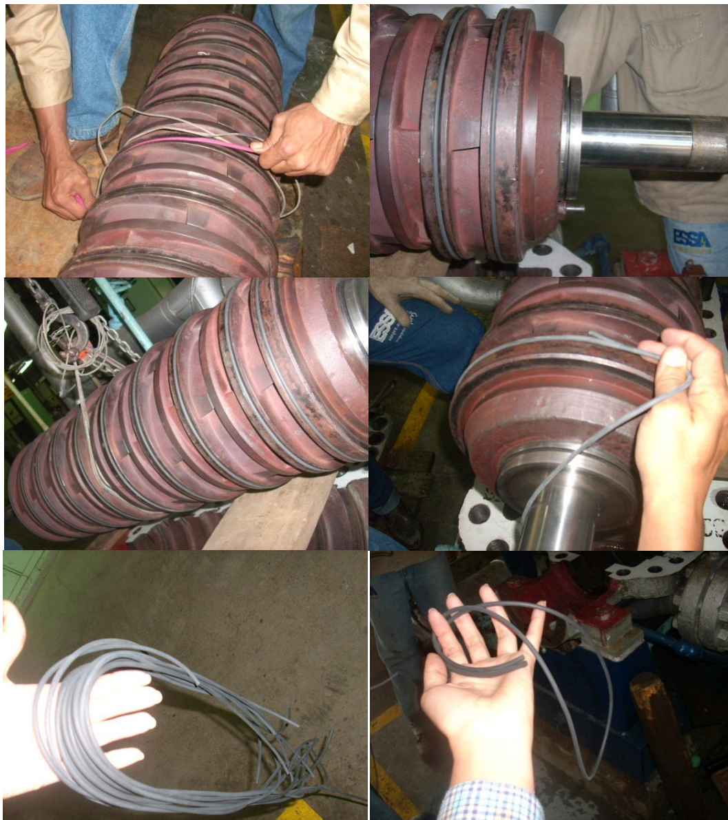
Limpieza y medidas para los anillos de vitón, sellos entre etapas – Bomba de alimentar caldera Unidades 1 y 2.
