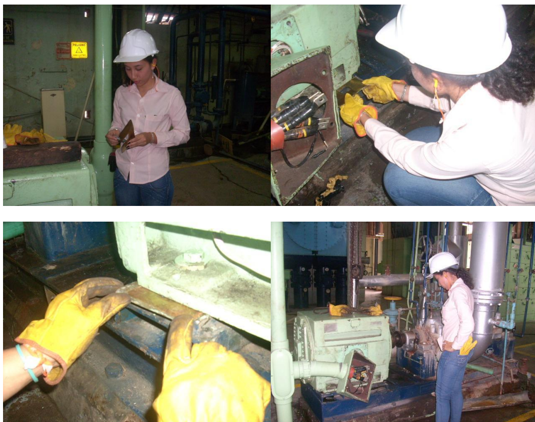
Calzando shims a las patas del motor (Alineamiento paralelo angular) – Motor bomba de alimentar caldera unidades 1 y 2.
