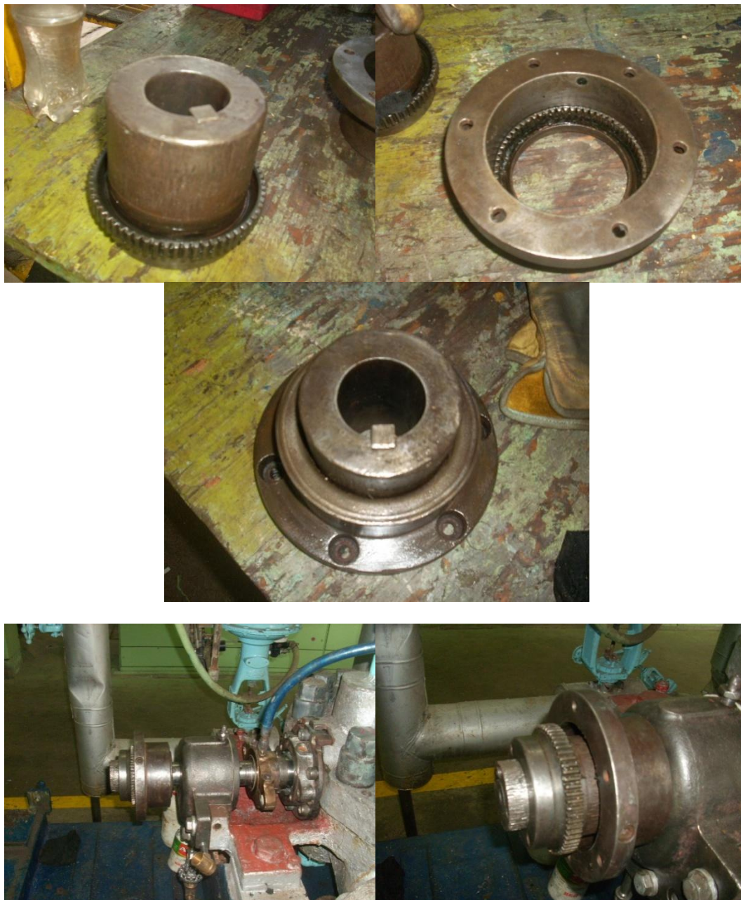
Acople rápido dentado de la bomba – Bomba de alimentar caldera Unidades 1 y 2.
