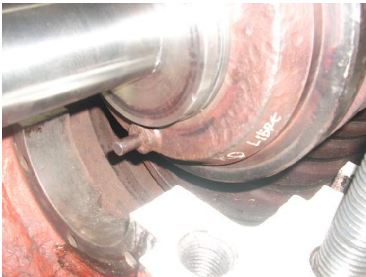
Sistema anitigiro para ajuste axial de los difusores con respecto a la carcasa – Bomba de alimentar caldera Unidades 1 y 2.
