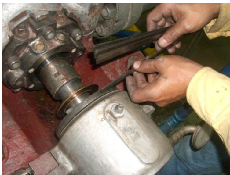
Desplazamiento axial de la bomba, medición con galgas para aproximar espesor de shims – Bomba de alimentar caldera Unidades 1 y 2.
