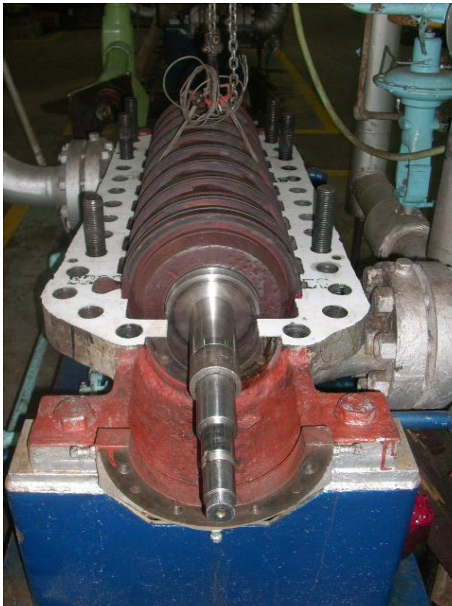
Eje instalado – Bomba de alimentar caldera Unidades 1 y 2.
