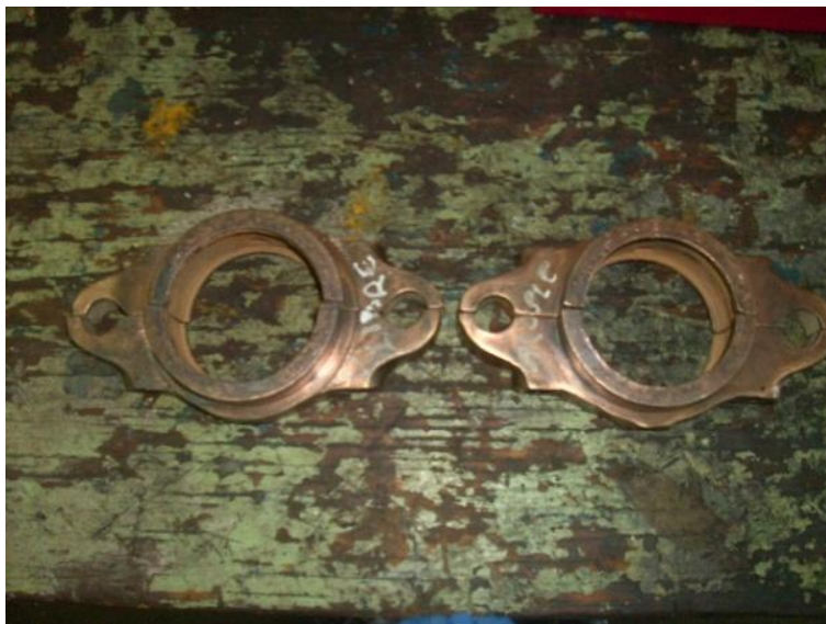
Prensa estopas – Bomba de alimentar caldera Unidades 1 y 2.
