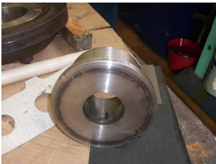
Cuñero y canal para O´ring de viton, Tambor de balanceo – Bomba de alimentar caldera Unidades 1 y 2.
