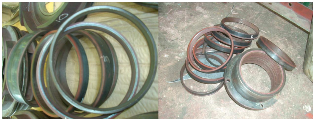
Anillos de desgaste y camisa del tambor de balanceo – Bomba de alimentar caldera Unidades 1 y 2.
