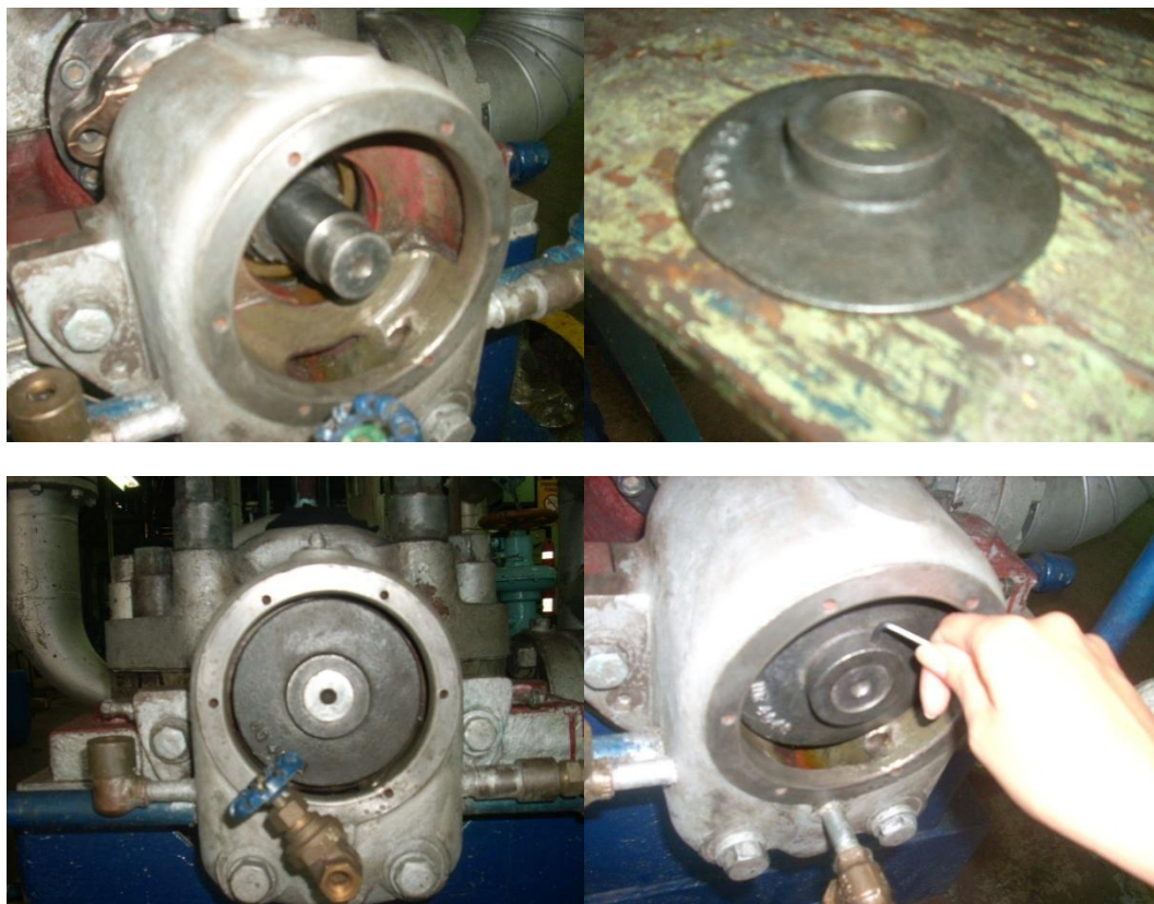
Instalación disco de chapoteo de aceite, lado empuje – Bomba de alimentar caldera Unidades 1 y 2.
