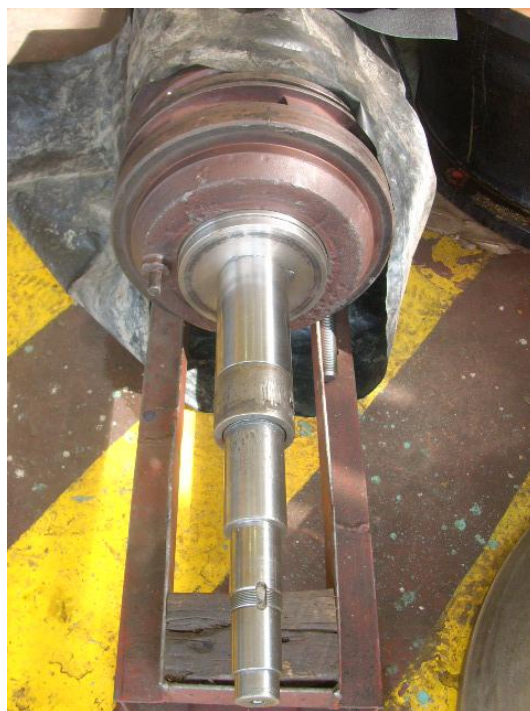
Etapas de balanceo, camisa del eje y tuerca, lado empuje – Bomba de alimentar caldera Unidades 1 y 2.
