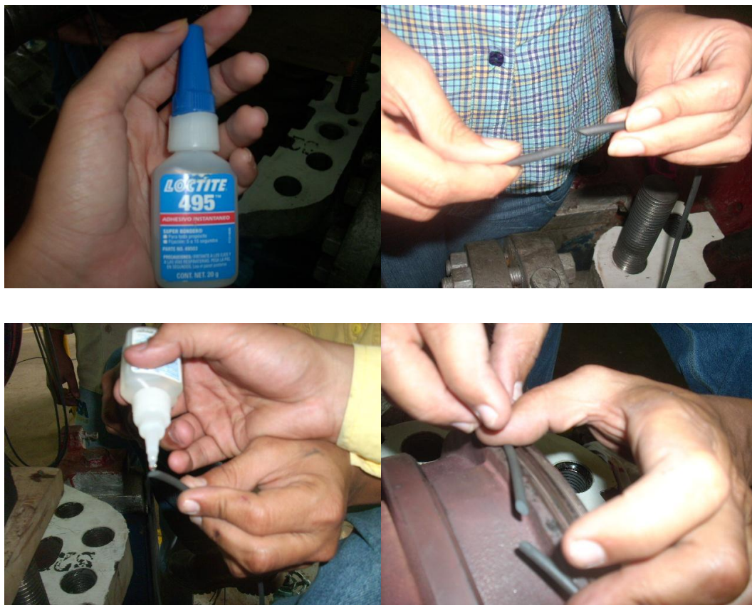
Pegante instantáneo industrial Loctite 495 para unir el vitón, corte sesgado – Bomba de alimentar caldera Unidades 1 y 2.
