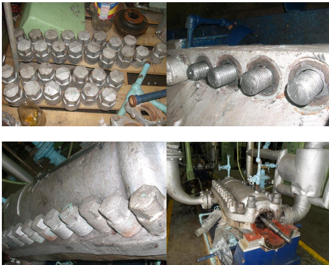
Tuercas de ajuste a la carcasa – Bomba de alimentar caldera Unidades 1 y 2.
