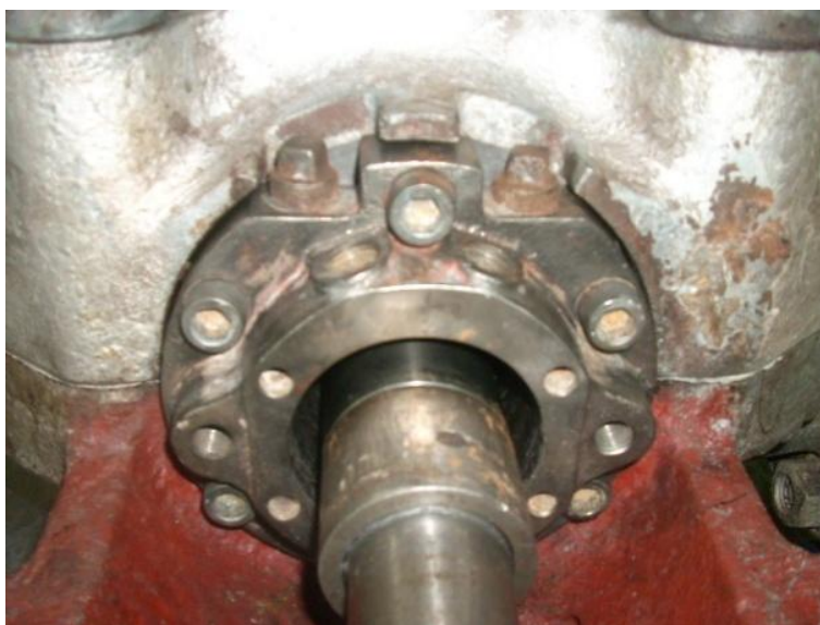
Instalación del Housing – Bomba de alimentar caldera Unidades 1 y 2.
