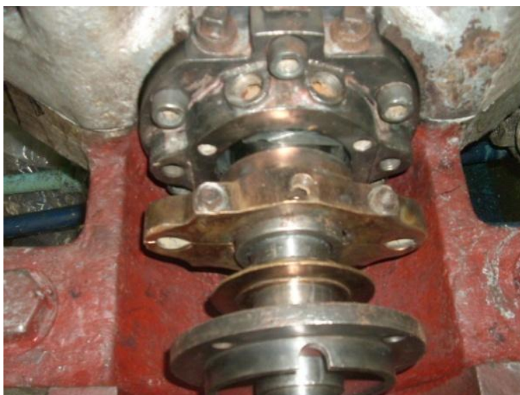
Housing, prensa estopas, deflector de agua, tapa interior chumacera, lado empuje – Bomba de alimentar caldera Unidades 1 y 2.
