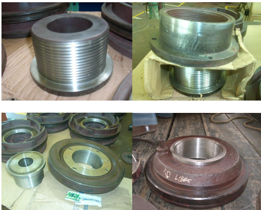
Tambor de balanceo, camisa del tambor de balanceo y cabezal de la camisa del tambor de balanceo – Bomba de alimentar caldera Unidades 1 y 2.
