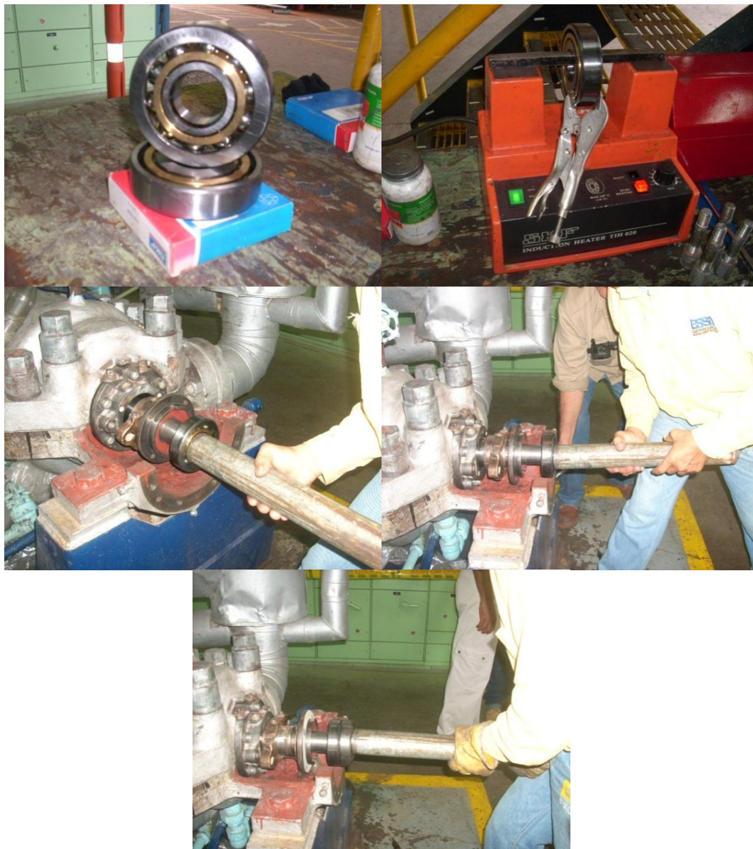
Instalación de rodamientos de una hilera de bola con contacto angular lado empuje utilizando calentador por inducción – Bomba de alimentar caldera Unidades 1 y 2.
