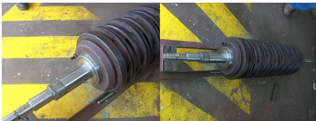
Conjunto ajustado de piezas estáticas y móviles del eje – Bomba de alimentar caldera Unidades 1 y 2.
