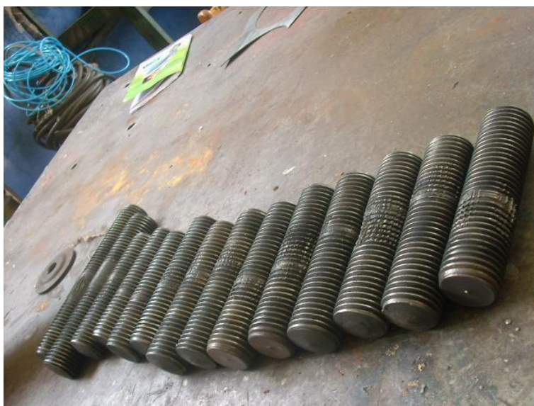
Limpieza espárragos con la grata – Bomba de alimentar caldera Unidades 1 y 2.
