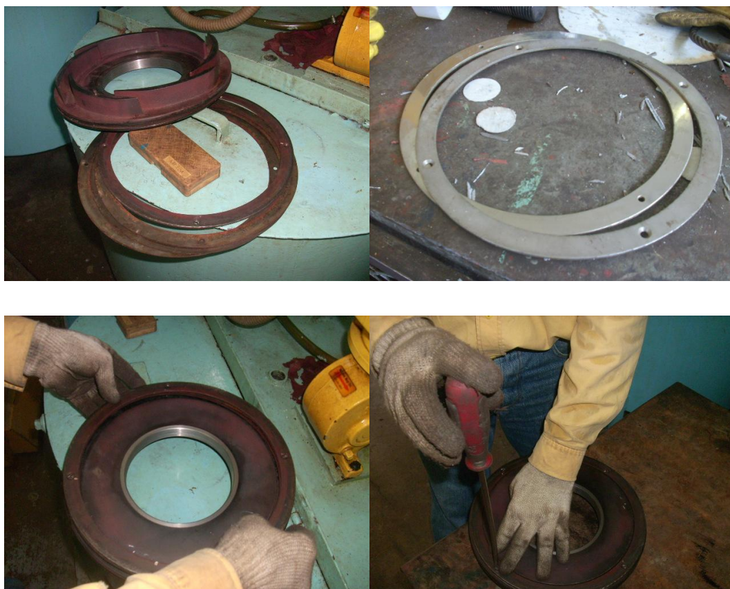
Shims para primera etapa (Ajuste axial de los difusores con respecto a la carcasa) – Bomba de alimentar caldera Unidades 1 y 2.
