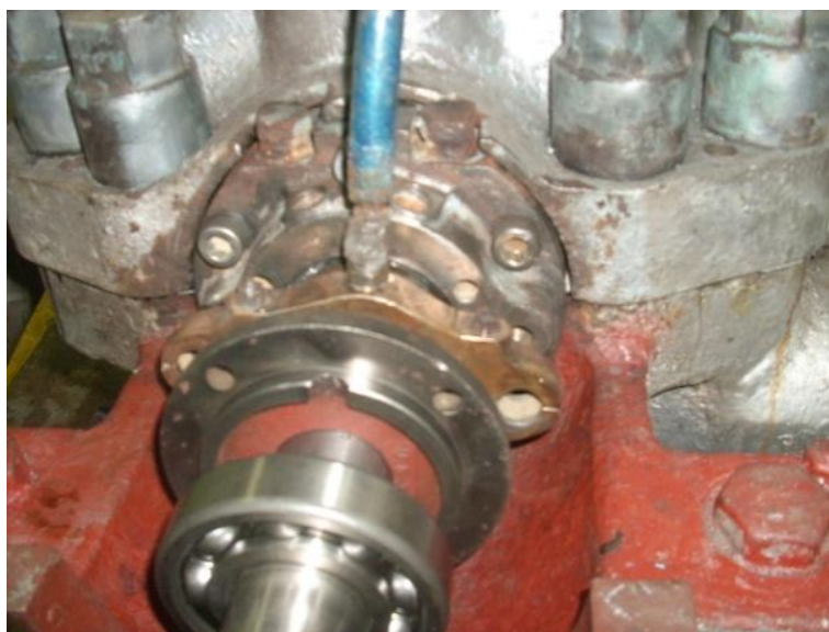
Rodamiento rígido de una hilera de bola, lado acople o succión– Bomba de alimentar caldera Unidades 1 y 2.
