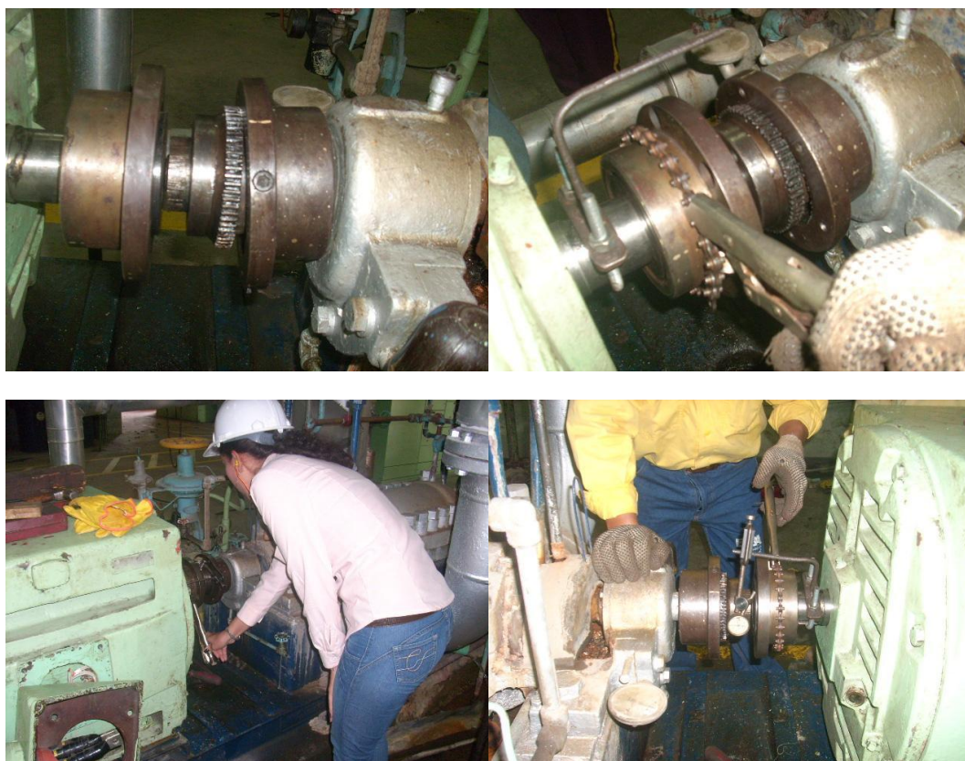
Hombre solo de cadena e indicador de carátula (Alineamiento radial) – Motor bomba de alimentar caldera unidades 1 y 2.
