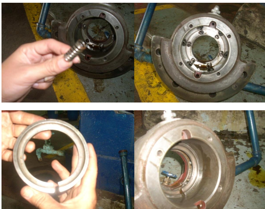
Resortes que absorben desplazamiento axial de la bomba y anillo espaciador en la chumacera de empuje – Bomba de alimentar caldera Unidades 1 y 2.
