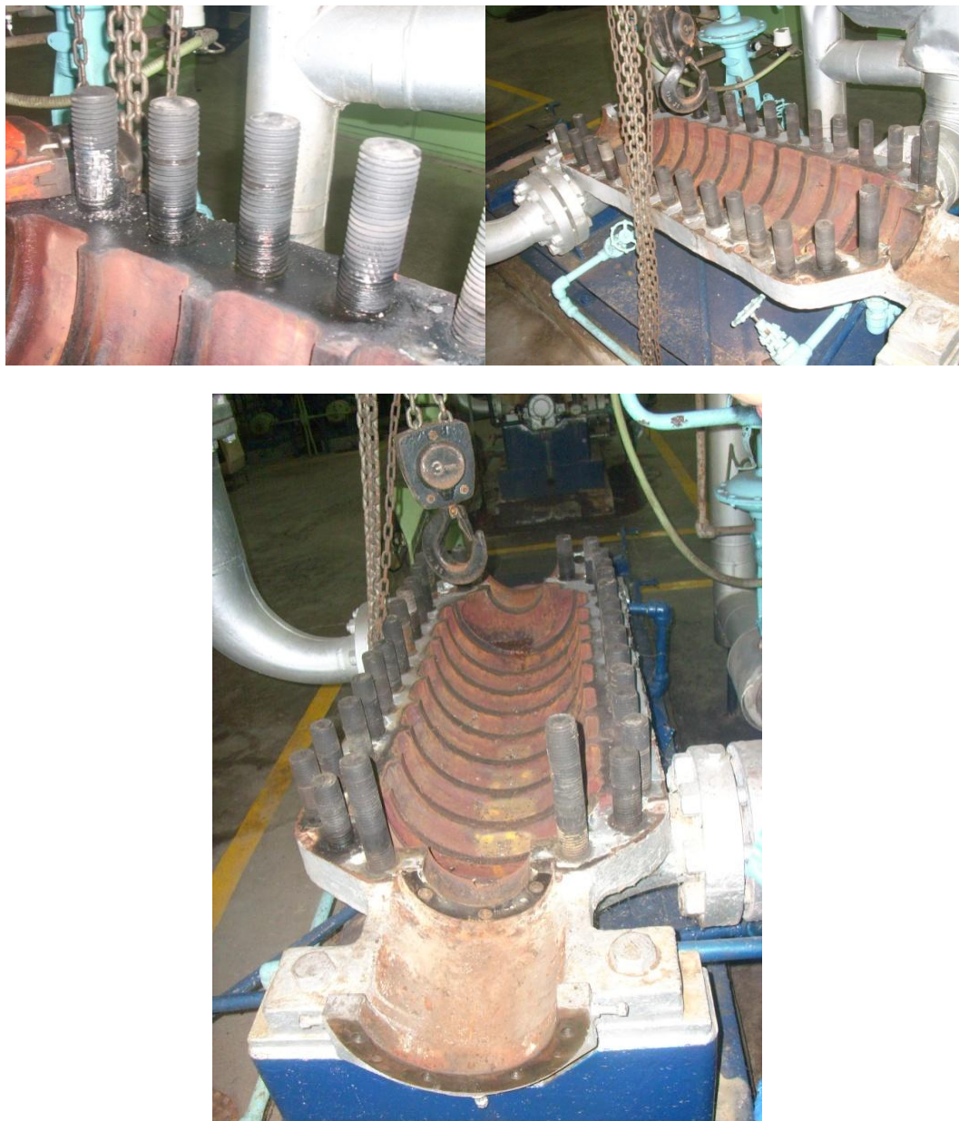
Tapa inferior de la carcasa con espárragos – Bomba de alimentar caldera Unidades 1 y 2.
