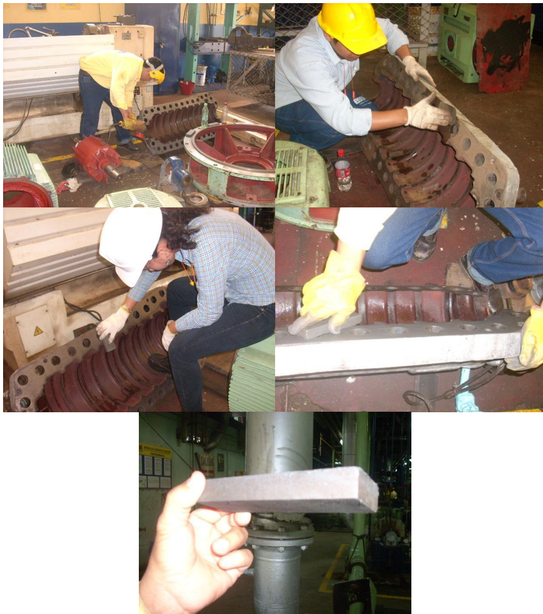
Limpieza con la grata y pulimento con piedra superficie tapa superior del cuerpo de la bomba – Bomba de alimentar caldera Unidades 1 y 2.
