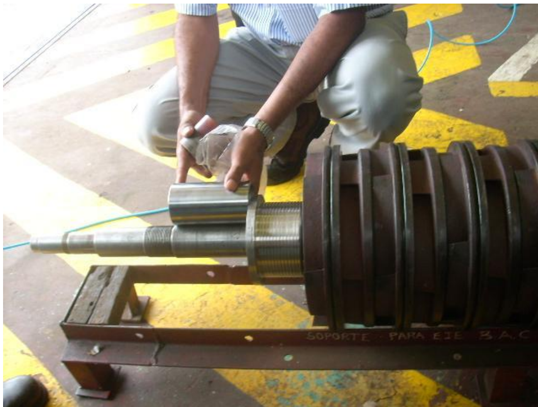
Camisa del eje – Bomba de alimentar caldera Unidades 1 y 2.
