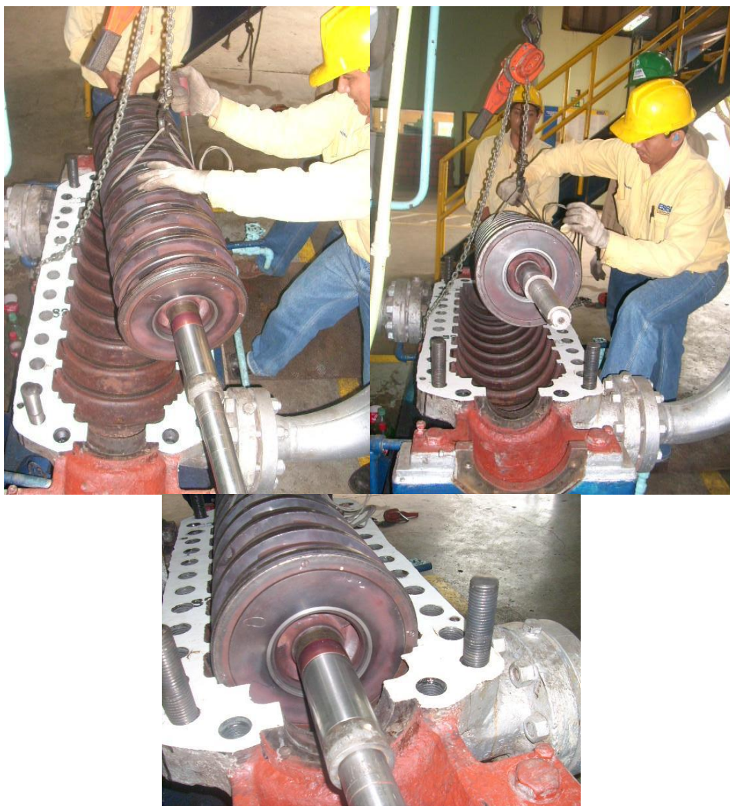
Instalación de eje con piezas móviles y estáticas – Bomba de alimentar caldera Unidades 1 y 2.
