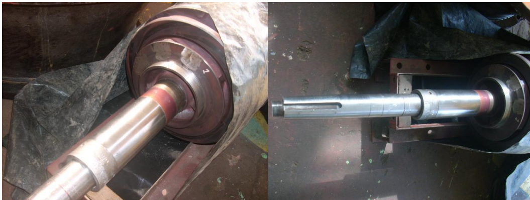
Separador, camisa del eje y tuerca lado acople; punta del eje cónica – Bomba de alimentar caldera Unidades 1 y 2.
