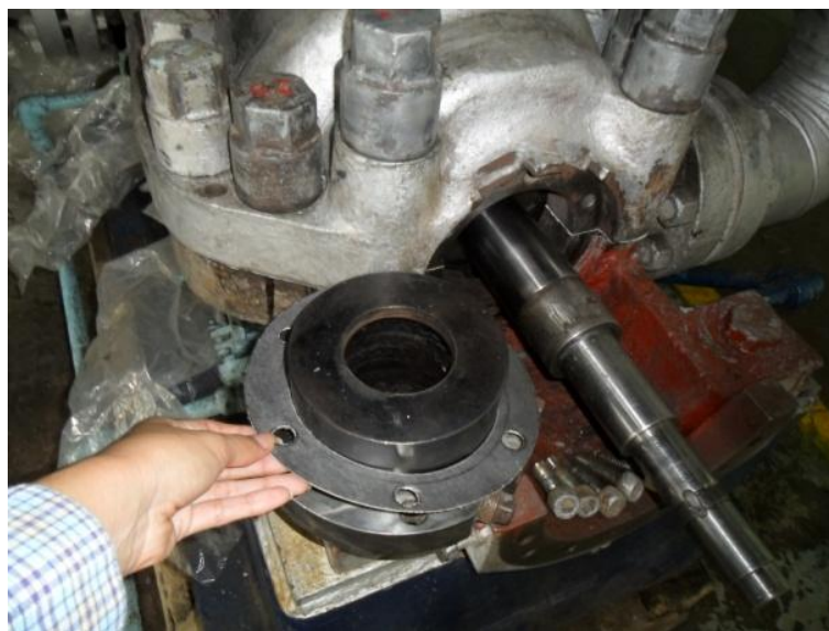
Housing o porta empaques, sello de asbesto grafitado con alma de acero – Bomba de alimentar caldera Unidades 1 y 2.
