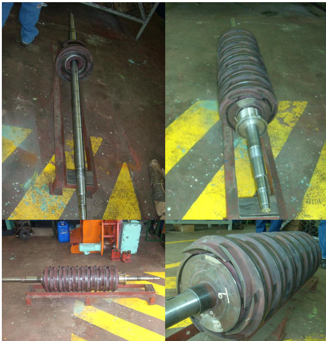
Instalación difusores e impulsores al eje de la bomba – Bomba de alimentar caldera Unidades 1 y 2.
