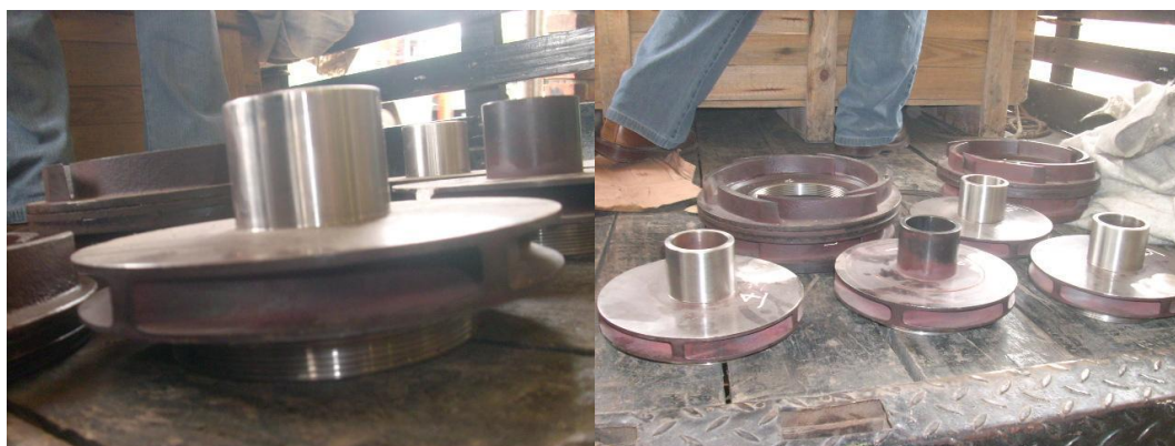
Impulsores – Bomba de alimentar caldera Unidades 1 y 2.
