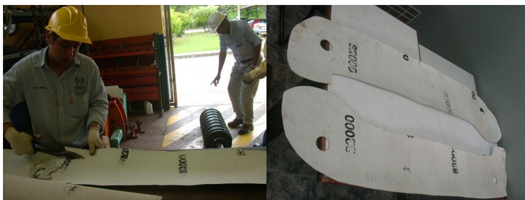
Empaque de asbesto; superficie de contacto entre las tapas de la bomba – Bomba de alimentar caldera Unidades 1 y 2.
